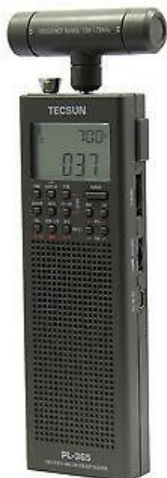
PL-365 con antenna esterna in ferrite
